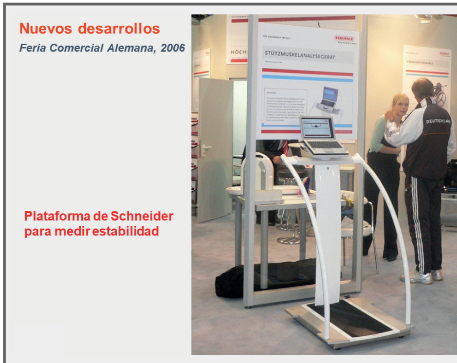
Figura 9-41. Plataforma de Schneider para medir estabilidad en base al balanceo.
