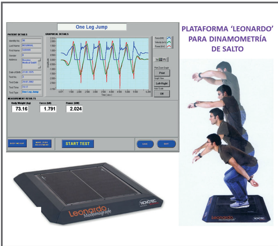
Figura 6-20a. Medición de la fuerza máxima de salto en alto, que usa la musculatura sural pero no la peronea, mediante una plataforma computada tipo 'Leonardo'.
