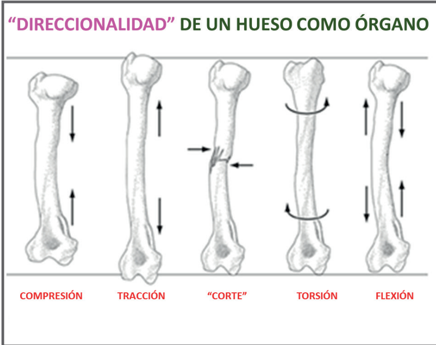
Figura 1-3. Las seis formas clásicas de deformación de cualquier cuerpo sólido, referidas a un hueso largo.
